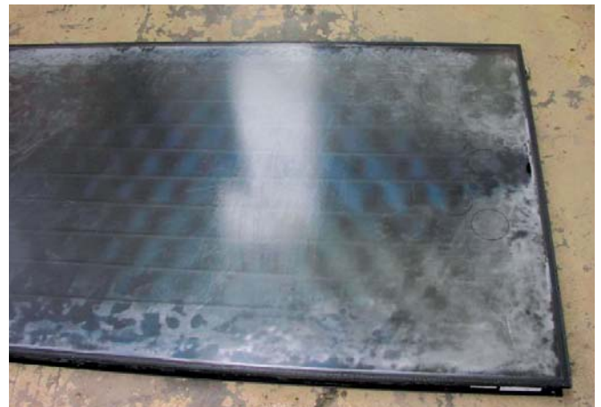
Bild 10: Beschlag der Scheibe durch Kondensat im Inneren des Kollektors
