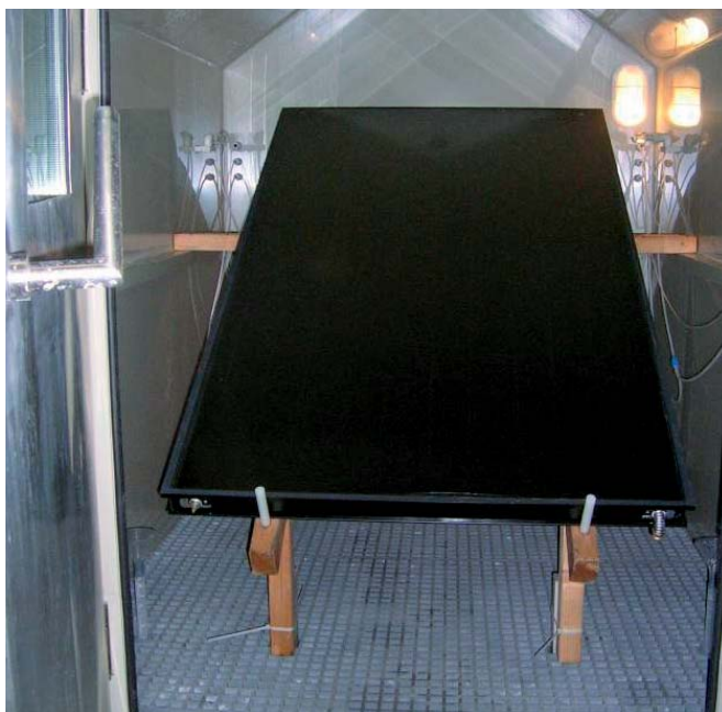
Bild 9: Anordnung des Kollektors in der Prüfkammer
