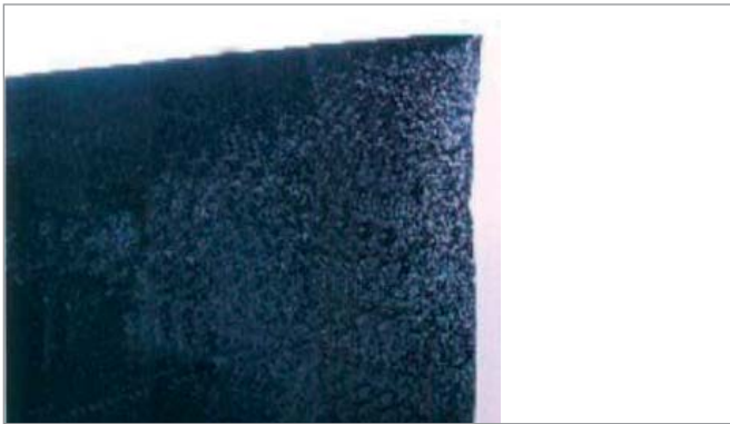
Bild 24: Verfärbung Absorberbeschichtung Picture 24: Discolouration absorber coating
